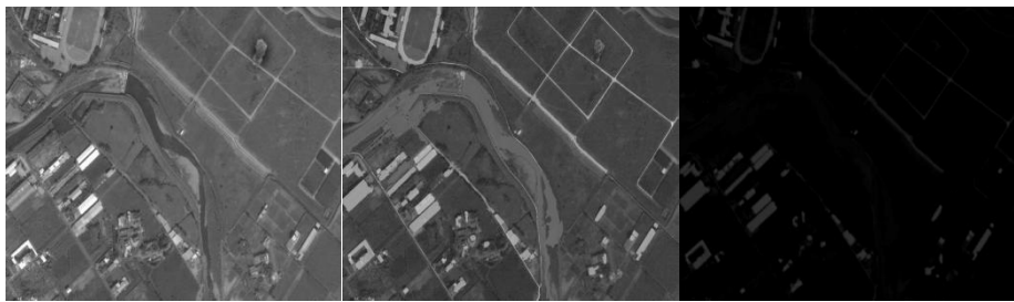
(a) 晴天地物红外模型 (b) 雨天地物红外模型 (c) 雪天地物红外模型
